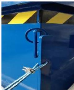
Tirer sur le câble depuis le chariot élévateur pour ouvrir la benne
