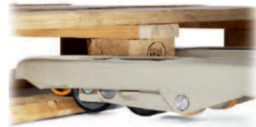
La rampe de sortie et les galets grimpeurs sont conçus pour une grande résistance aux impacts et une longue durée de vie. Pour l'opérateur, l'entrée et la sortie de palette deviennent alors bien plus faciles, même si celle-ci est vide. Une hauteur de fourches abaissées de seulement 75 mm permet de travailler facilement sur des palettes hors normes ou endommagées.
