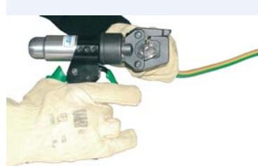
Déclenchement automatique avec "clic" audible lorsque la force de 35 kN est atteinte. Retour du piston par levier de décharge.
