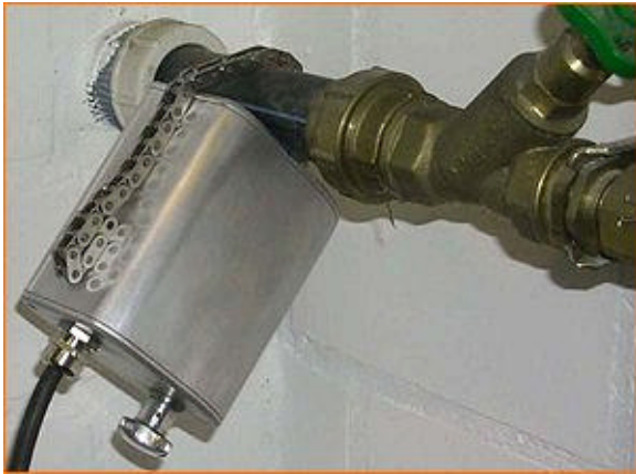
Utilisation du Vibreur P sur un branchement domestique Eau ou gaz
