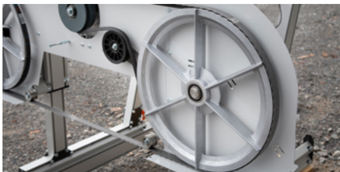
Volants avec des pales de ventilateur, qui refroidissent la lame et maintiennent le couvercle propre.
