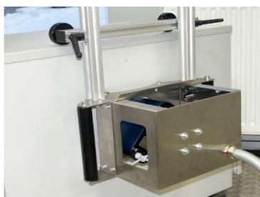
Poignée à gâchette avec tête de marquage intégrée et câble de connexion coudé, idéal pour les applications de marquage à la verticale et à l'horizontale (+ guidage supplémentaire)
