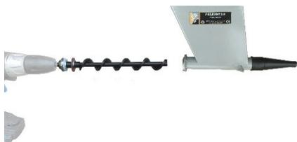
Retirer la vis sans fin de la cuve, puis la monter dans le mandrin de la perceuse.
