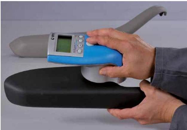
La nouvelle gamme des spectro-guides S offre des performances techniques améliorées pour le brillant à 60° dans la gamme des bas brillants 0 - 10 UB. Une excellente répétabilité de +/- 0,1 est garantie grâce à notre procédé de calibrage breveté.
