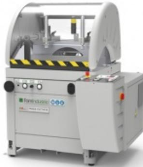
**Tronçonneuse à une tête ascendante avec positionnement électronique de l'axe vertical**
