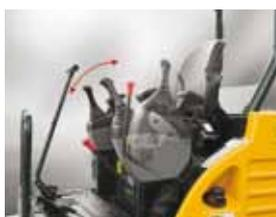
La console gauche est inclinable et facilite l'accès à la cabine. Un verrouillage de sécurité empêche l'opérateur de quitter la cabine avec des leviers de commande hydraulique actifs. Les fonctions hydrauliques sont désactivées lorsque le levier de sécurité et la console gauche sont relevés.
