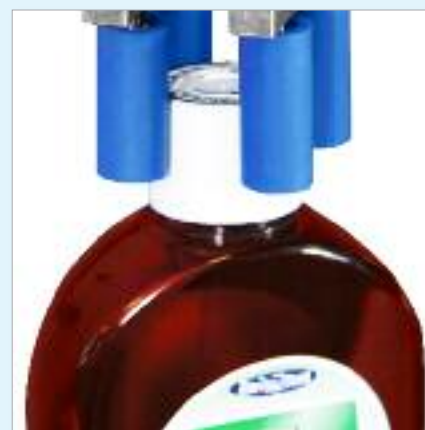
Test sur bouchon de sécurité enfants CRC
