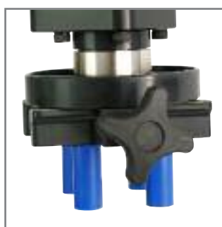
Plateau de préhension supérieur (ne peut pas être utilisé avec les capteurs d'une capacité inférieure à 6 N.m)
