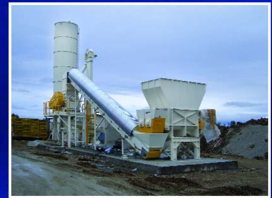
Installation pour le traitement de déchets de béton cellulaire
