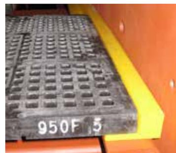
Module à bord large LS-S-290-500, avec profilé Pu définition pour plan de pose.
