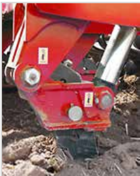
La dent Pro-lift à sécurité hydraulique est disponible sur le DTX.
