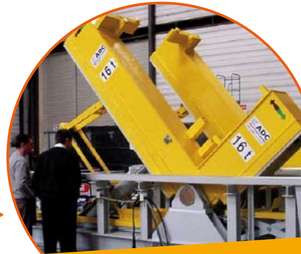
Basculeur / Tipper : 16 tonnes ▶
