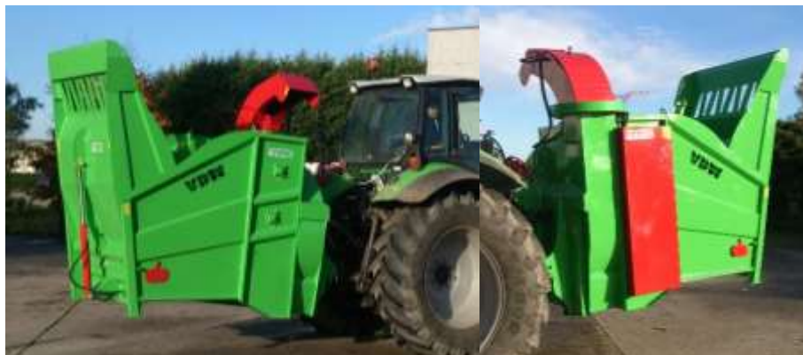
Boven: Standaard gedragen stroblazer met draai pijp
