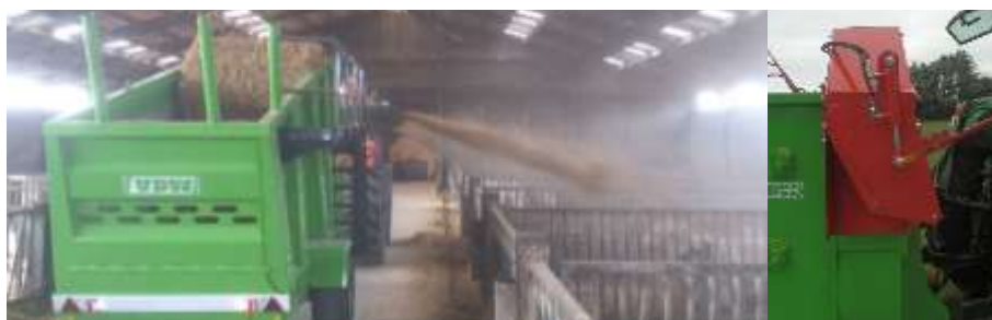
Boven: Mega stroblazer, strooit 5 pakken in 5 minuten. Rechts: optie 45° draai pijp
