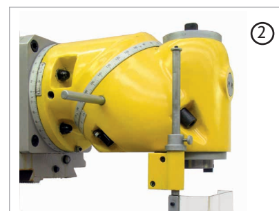
Modèle Digi simple d'utilisation avec visualisation numérique LED précise des positions et déplacements
