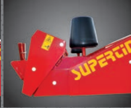
Il rullo basculante permette di fasciare balle con diametro da 90 a 160 cm.
