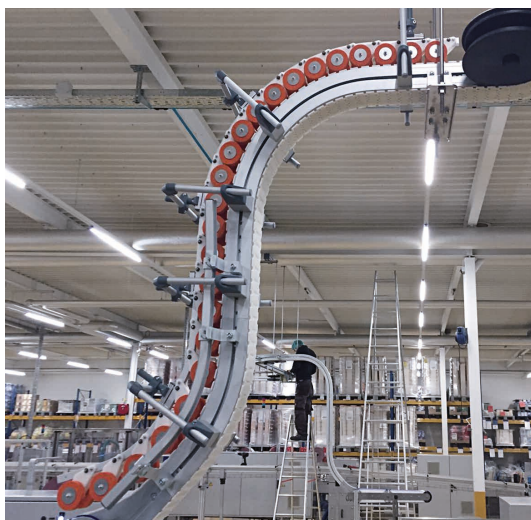
Convoyeur à chaînes à charnières en composite Versaflex avec galets presseurs pour le transport vertical
