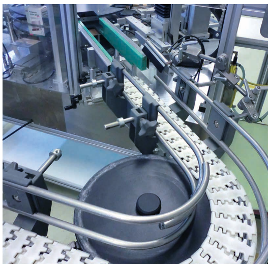
Convoyeur à chaînes à charnières en composite Versaflex avec courbes à roue et guidage latéral
