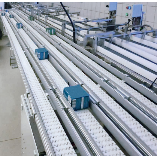
Convoyeur à chaînes à charnières en composite Versaflex en tant que système parallèle à plusieurs voies
