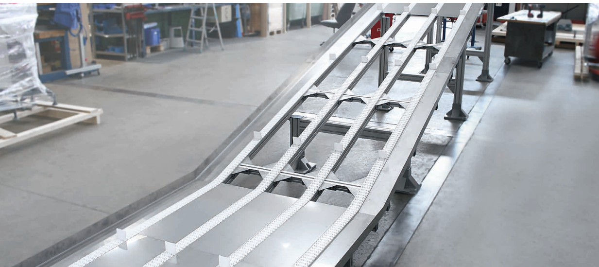
Convoyeur à chaînes à charnières en composite Versaflex à 4 voies A06 avec taquets pousseurs intermédiaires
