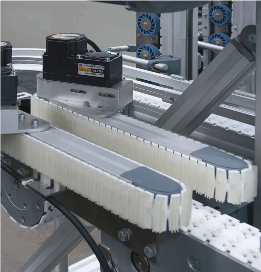
Convoyeur à chaînes à charnières en composite Versaflex en tant que convoyeur de serrage
