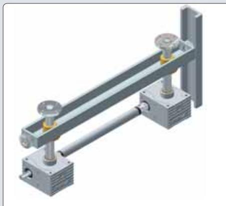
Il faut veiller au parallelisme et à la perpendicularité des faces de fixation, écrous et guidages entre-eux.
