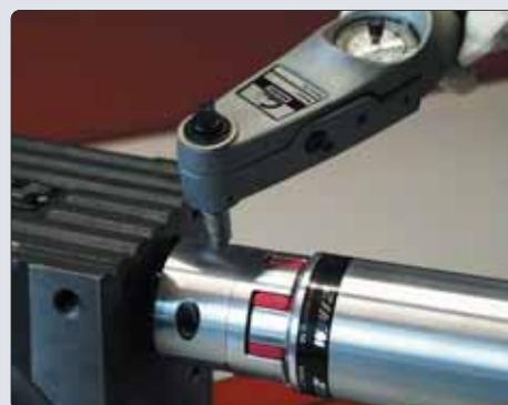
Appliquer le couple de serrage des vis conformément au tableau
