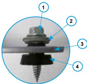
Alors qu'une vis autoforeuse standard évacue la matière du perçage en copeaux, la vis Drillnox DBS2 6x27 refoule la matière vers l'intérieur en formant un bourrelet, ce qui augmente la longueur d'implantation. Le couple de forage reste ainsi élevé même dans les petites épaisseurs (> 5 N.m contre une moyenne de 1.5 N.m pour les vis autoforeuses classiques). **Pour une fixation plus sûre, nous préconisons l'option «Douille Limiteur de Couple DB CONTROL 5N.m» (cf options).**
