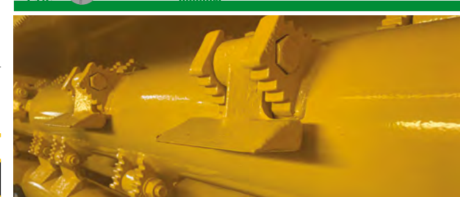
Position du rouleau autonettoyant avec éjection du produit derrière le rouleau pour meilleure vitesse d'avancement
