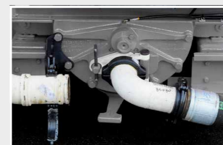
Sortie orientable (pour le pompage avec des flexibles)
