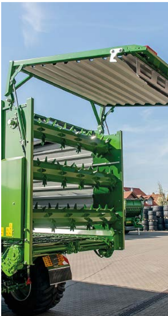
Entraînement direct du rouleau démêleur inférieur via un boîtier à renvoi d'angle placé sur la paroi latérale du véhicule.
