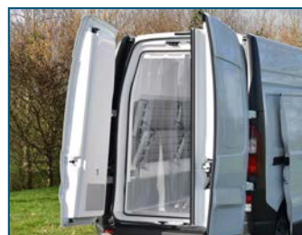
Isolation des ouvrants d'origine par des contre-portes isothermes. Etagères réglables ( option ), rideau anti-déperdition à lamelles ( option ).
