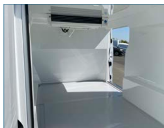
Aménagement intérieur : plancher antidérapant avec passages de roue caissonnés, revêtement parois lisse teinté blanc.
