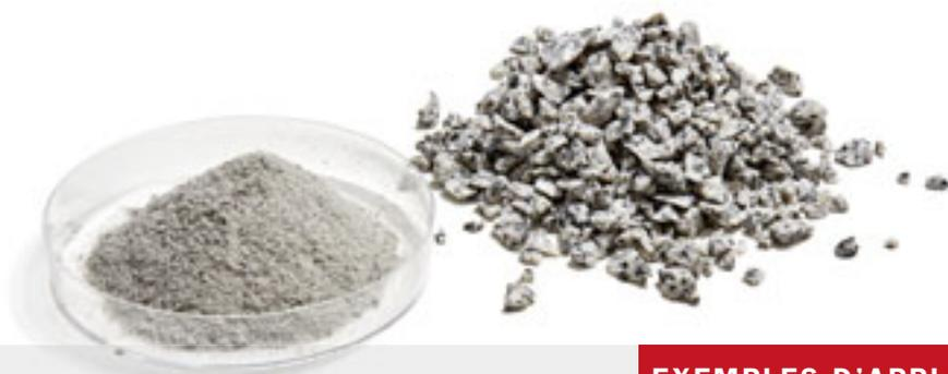
Préparation optimale d'un échantillon de granite avec le micro-broyeur planétaire PULVERISETTE 7 *premium line*
