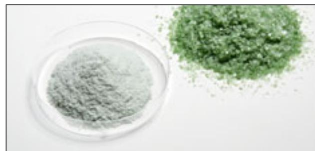
Verre avant et après le broyage avec le micro-broyeur planétaire PULVERISETTE 7 *premium line*
