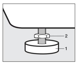
■ Tournez le contre-écrou 2 dans le sens des aiguilles d'une montre avec la clé multiple fournie. Dévissez le contre-écrou 2 avec le pied 1.
