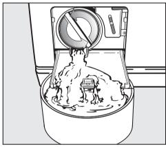
■ Dévissez le filtre jusqu'à ce que de l'eau s'écoule.
