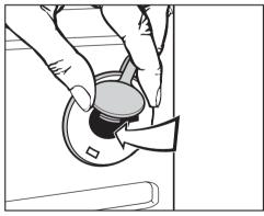
■ Fermez les orifices avec les bouchons attachés aux sécurités.
