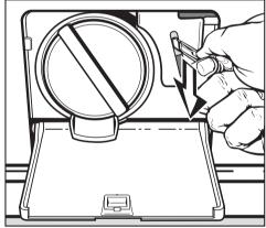
■ Tirez le déverrouillage de secours vers le bas, par exemple avec le manche d'une cuiller. La porte s'ouvre.
