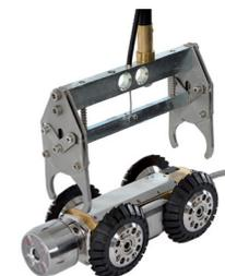
Pour un déploiement et une récupération rapide du robot, dans le cas où l'accès des canalisations se fait par un regard vertical, il vous est proposé un choix de deux nacelles de descente (100 et 150 mm).
