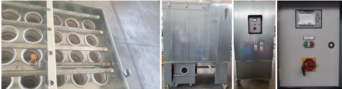
Conformité ATEX : le groupe PJ200S est ATEX zone air sale (intérieur de cuve) et zone air propre (turbine, moteur, partie électrique. Il peut donc être utilisé en zone ATEX 21 et 22.
