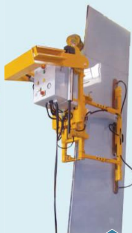
Palonnier avec contrepoids pour manipuler des épines
