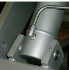
Vérin avec soupape de sûreté intégrée.
