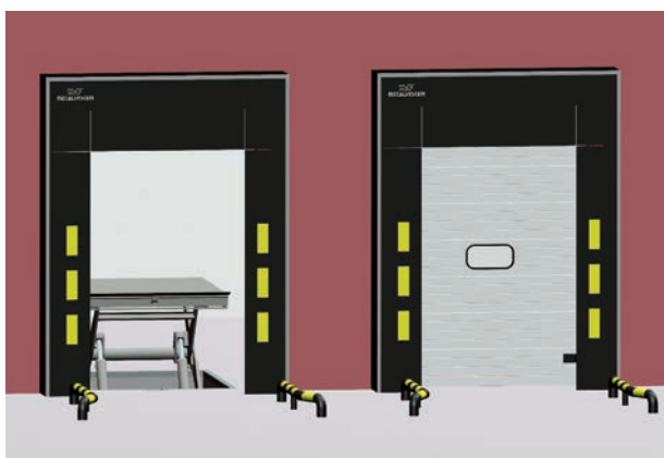
Quai de chargement sans dénivelé.
