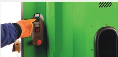
Cycle automatique de montée-descente de la plaque de compactage
