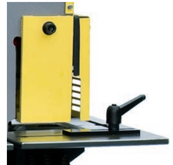
Station d'encocheuse, table avec butée et réglét
