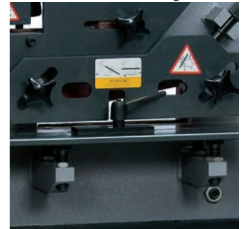
Station de cisaille plat, table avec butée et angles réglables
