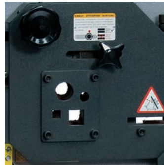
Station barres en acier avec principe de serrage de la pièce
