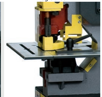
Station de poinçonnage, capacité max 28 x 15 mm et 38 x 11 mm
