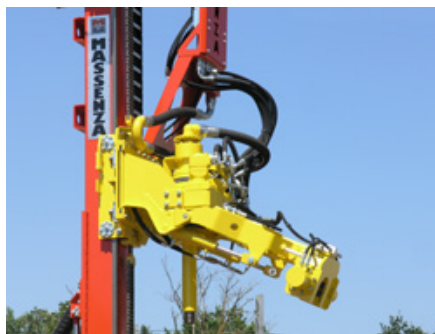
Braccio carica aste Rods loading arm Bras de chargement de tiges Brazo de carga barras Bohrrohr handling system Автоподатчик штанг
