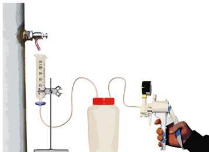
Facilement démontable, cette pompe manuelle peut être nettoyée ou réparée par l'utilisateur, un kit de réparation est disponible sur le marché.
