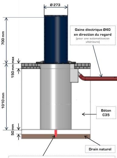
Tubes d'évacuation PVC à raccorder au pluvial, ou à remplacer par une couche drainante capable d'absorber 20L en moins de 5min. (Il est important de ne pas faire dépasser ce tube à l'intérieur du caisson)
