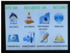
**afficheur tactile** convivial permettant la gestion aisée des paramétrages et de la maintenance. (Sur devis nous pouvons développer des fonctionnements particuliers). Une **horloge programmable** annuelle est intégrée de série aux automates et permet 4 plages d'ouverture journalières (elle peut aussi être utilisée en horloge externe pour activer/désactiver un matériel).
