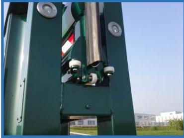
**La signalisation est assurée par 2 feux à éclat à leds de couleur orange à très longue durée de vie sur le poteau technique et 2 projecteurs hublots à leds, sur le portique avant.**
