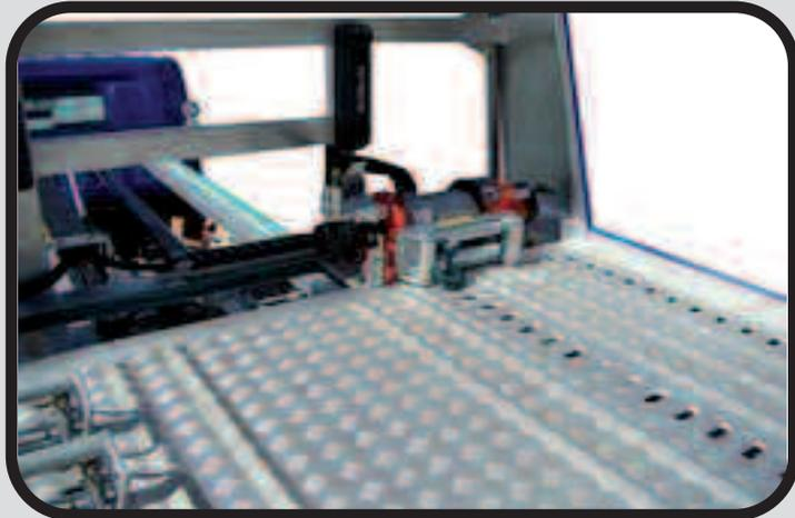
\* Treuil hydraulique 4,5T avec déplacement manuel et commande à distance RADIO
