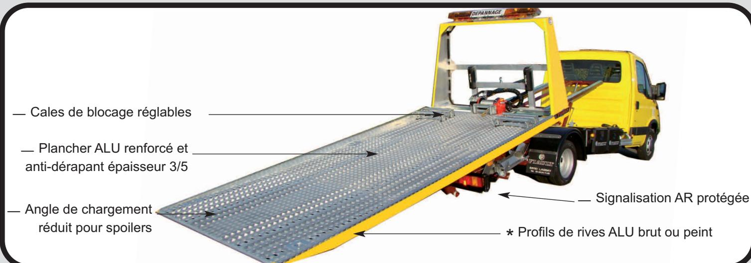
Faux-châssis – Basculeur – Plateau 100% Aluminium soudé
