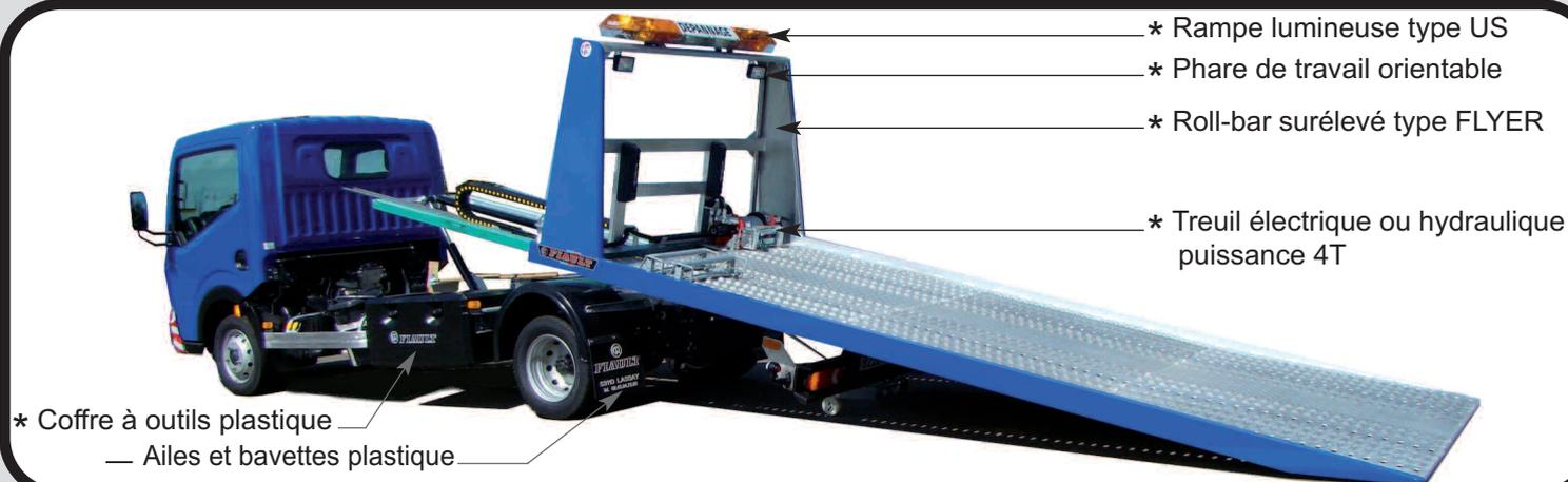
Capacité technique : 2000 kg – Longueur : 4800 mm x Largeur : 2100 mm
