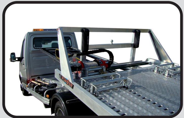
— Roll-bar standard avec rampe EVO sur cabine
