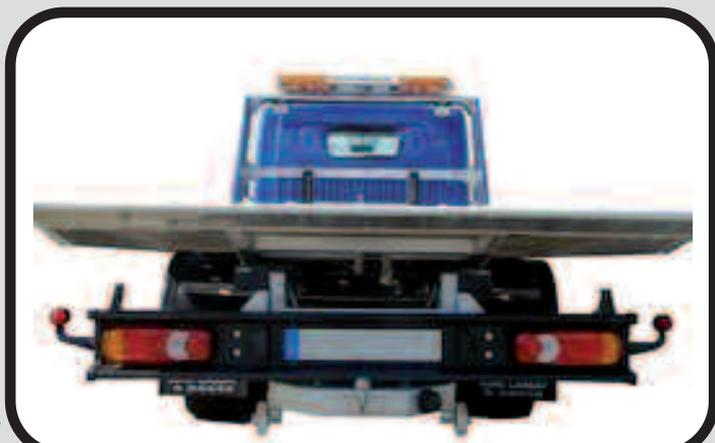
— Pare-chocs arrière et attelage à boule standard Ø 50
