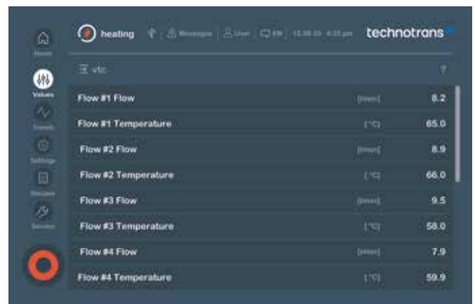
Unité d'affichage et de contrôle logotherm avec écran multipoint 7"
