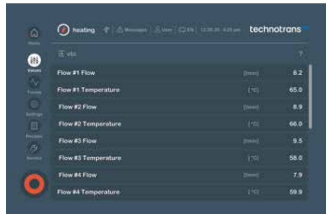
Affichage, communication, fonctionnement des unités de contrôle de la température via l'écran tactile de 7 pouces
