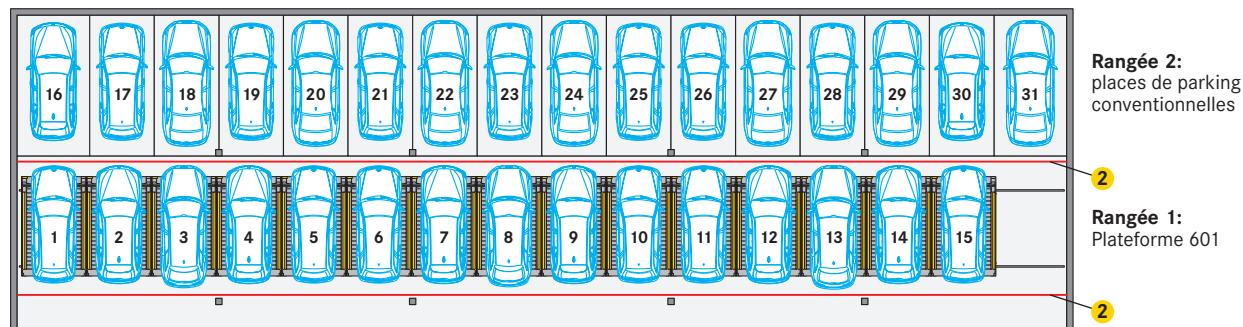
② Si la longueur du rail est supérieure à 30 m, des barrières lumineuses conformes à la norme DIN EN 14010 doivent être prévues.
