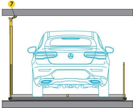
① Distance maximale de 2 cm entre la Plateforme et le sol. Les normes de sécurité selon la norme DIN EN 14010 sont respectées.
