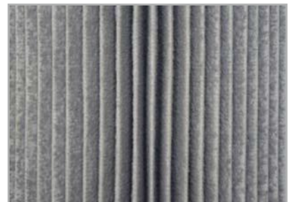
cartouche filtrante après nettoyage
