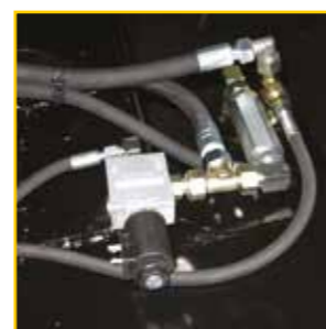
Moteur hydraulique pour montage sans drainage
