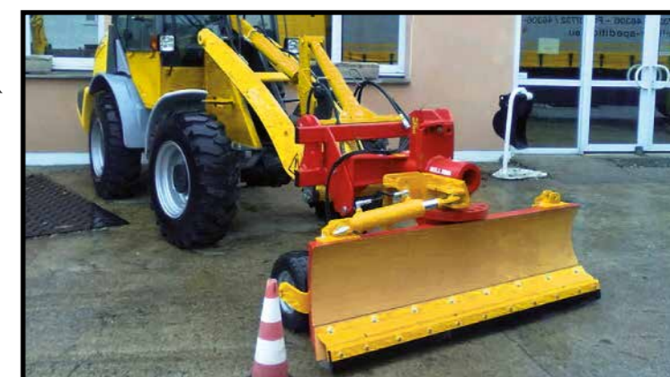
LAMES NIVELEUSES et LAMES DE DÉNEIGEMENT . - Large gamme adaptée à vos besoins : nivelage, déneigement, nettoyage, remblayage, déblayage, curage, terrassement... - Plus de mouvements : inclinaison, rotation et déport.
