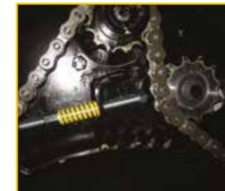
Grande couronne d'entraînement (pas de réducteur) avec tendeur de chaîne extérieur (sauf TURBOMIX 230 GB)
