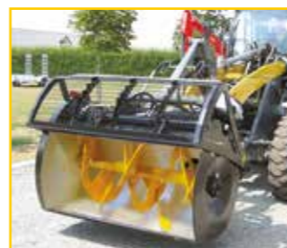
Grille galbée pour une meilleure visibilité. Articulation de la grille depuis le poste de conduite.
