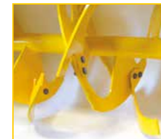
Pales boulonnées interchangeables rapidement
