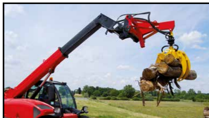
GRAPPIN DE MANUTENTION adaptable sur chargeurs avant, télescopiques, grues forestières, mini-pelles... - Charge maxi. 1,5 T. - Grâce au rotator, rotation du bois sur 360°.
