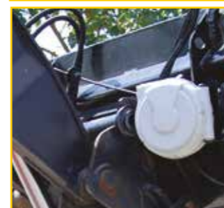
Enrouleur électrique 15 m ou Rallonge électrique 5 ou 12 m avec bouton poussoir en cabine
