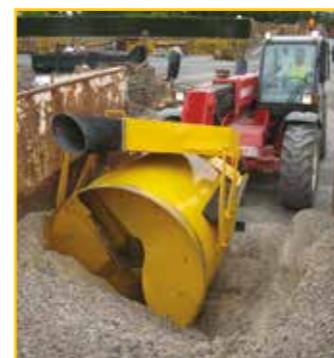
Chargement automatique par simple rotation de la bétonnière
