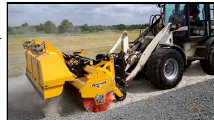
Très large gamme de BALAYEUSES aligneuses ou ramasseuses. - Tous types d'utilisations : balayage des voiries, en collectivités, sorties de chantiers, entrepôts travaux publics... - Largeurs de balayage de 1,50 m à 4,40 m.
