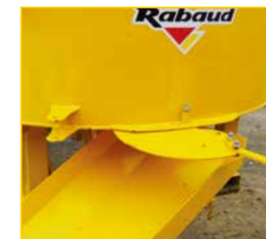
Trappe de vidange manuelle dans l'axe du porteur
