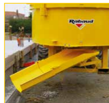
Goulotte de déversement avec rallonge escamotable. Vidange au-delà du gabarit du porteur
