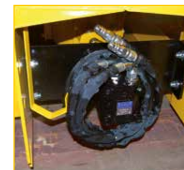
Moteur hydraulique (option)
