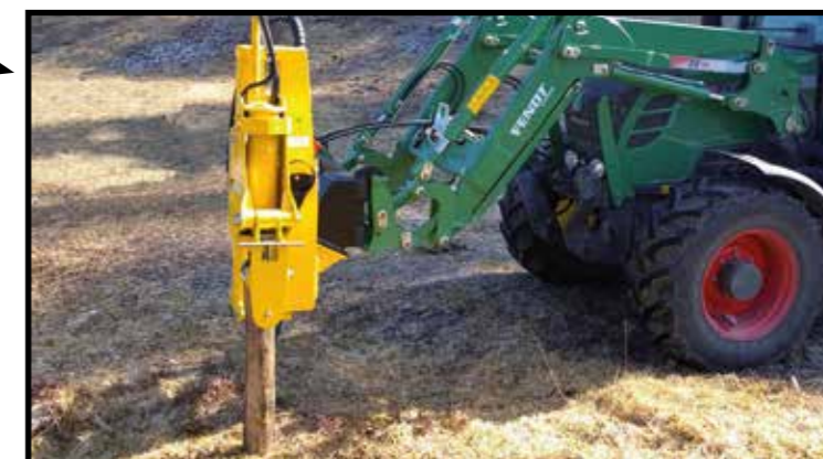
ENFONCE-PIEUX adaptable sur télescopiques, chargeur frontaux... - Enfonce les pieux de toutes natures, dans tous les terrains. - Cloche de frappe Ø 120 mm ou 150 mm, garantie 2 ans. - Descente du marteau par vérin de traction.
