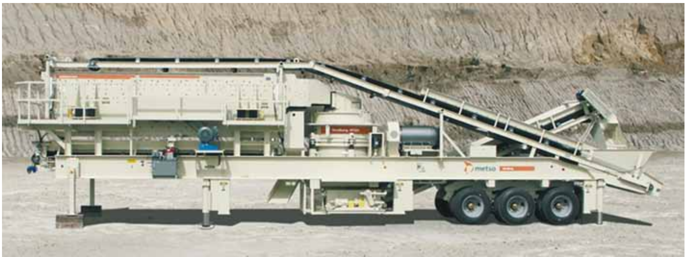
Application mobile : Broyeur à cône HP300 en version groupe mobile.
