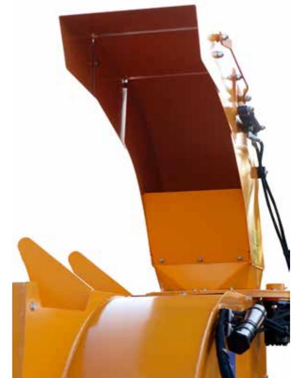
Goulotte Orientable 270°, paillage 15 m à droite, paillage 13 m à gauche
