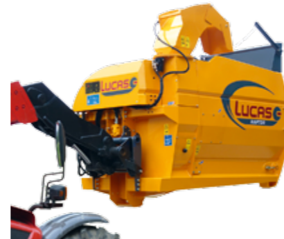
Raptor télescopique : attelage sur la flèche du télescopique
