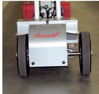
Mouvement latéral pour l'ajustement de précision avant la pose
