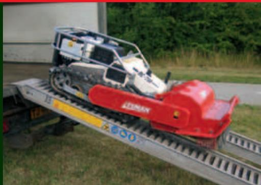
La débroussailleuse Timan RC-750 est un partenaire performant et efficace lorsqu'il s'agit de tondre des talus en pente jusqu'à 50 degrés. Le RC-750 permet de travailler en toute sécurité sur toutes les parcelles difficiles d'accès. Sa transmission radiocommandée sur un train de roulement à chenilles et un centre de gravité particulièrement bas permet de travailler et de manoeuvrer en toute sécurité dans les situations les plus difficiles.
