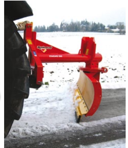
Lame spéciale déneigement avec caoutchouc anti-abrasif de 30 mm d'épaisseur
