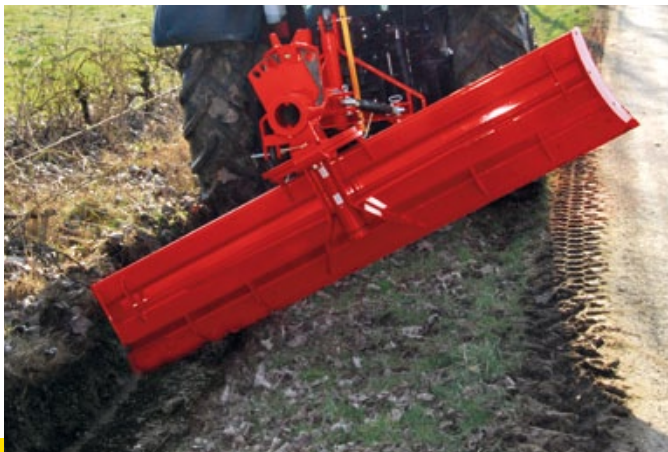
LAME STANDARD en position inclinée pour la création de saignées dans l'accotement ou la création de fossés
