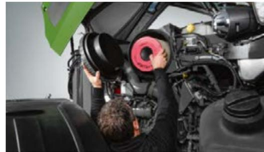
Le niveau d'encrassement des filtres à air s'affiche sur le terminal Vario. Le compartiment moteur est facilement accessible avec ses panneaux latéraux amovibles.
