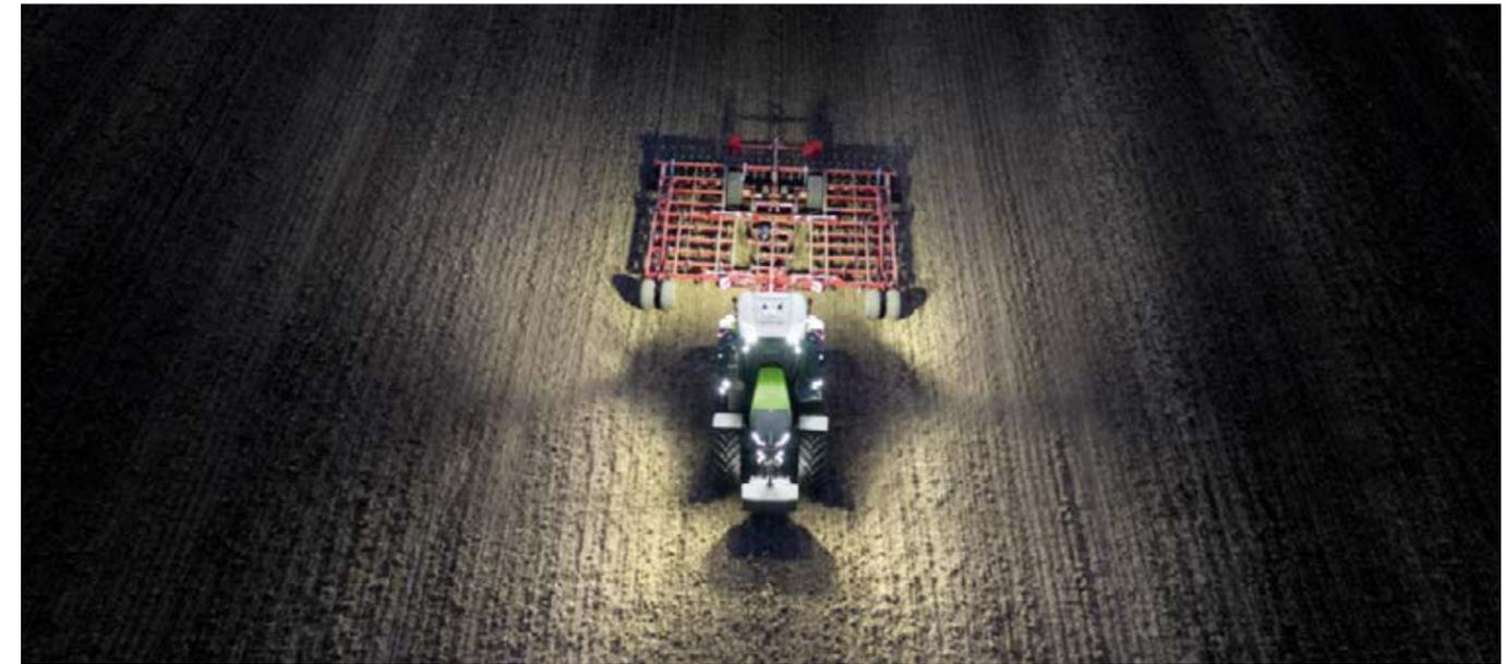
Au total, 66 230 lumens de lumière LED offrent un éclairage périphérique maximal et une visibilité parfaite de nuit.
