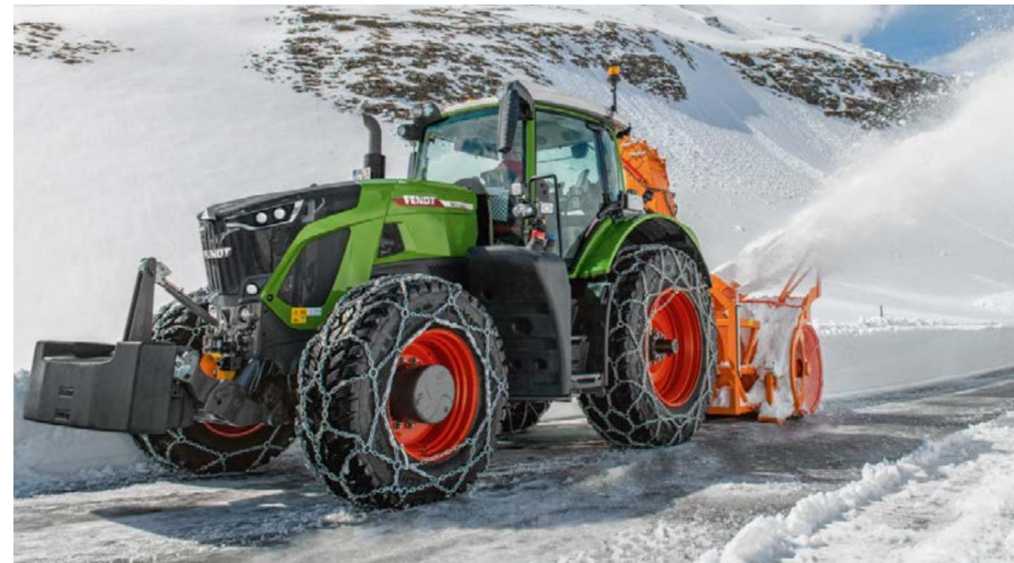
Inversez totalement le sens du poste de conduite, pour un meilleur confort et une visibilité optimale sur l'outil. Les stabilisateurs hydrauliques facilitent l'attelage de l'outil. L'essieu barre garantit un haut niveau de flexibilité avec différents pneus et différentes voies.
