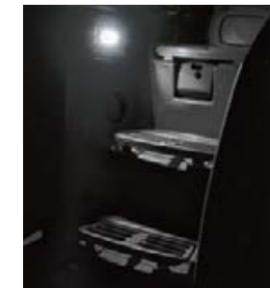
De nuit, montez et descendez en toute sécurité de la cabine, grâce à l'éclairage d'entrée intégré sur le côté du réservoir.
