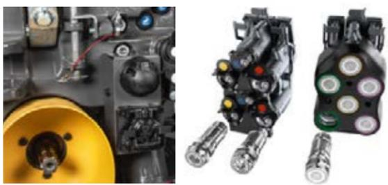
À l'avant, le Fendt 900 Vario propose en option un relevage intégré avec contrôle de la position et de report de charge. Vous pouvez également installer jusqu'à deux distributeurs frontaux, pour un débit maximum de 100 l/min, une prise de force avant et une prise ISOBUS.
