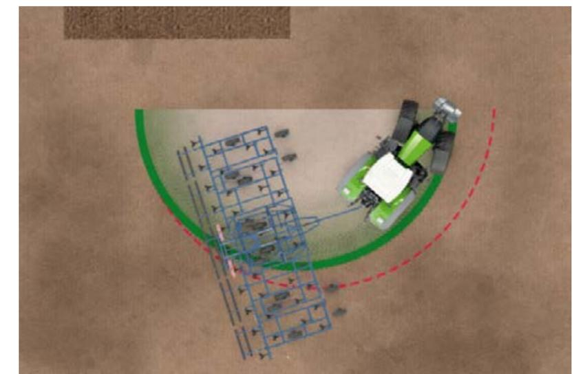
Rayon de braquage réduit grâce à l'effet de « pull-in turn », par exemple 6,1 m sur le Fendt 930 Vario avec pneus standard.
