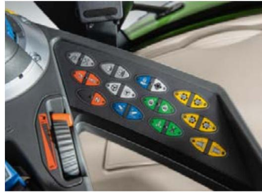
Toutes les commandes sont disposées de manière simple et claire sur le clavier à effleurement.
