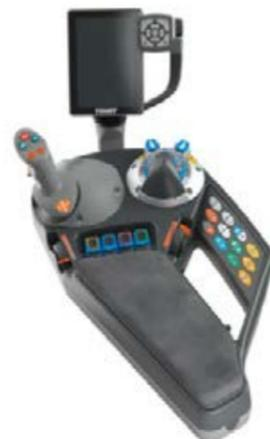
Le joystick Profi comporte quatre touches pour le système de gestion des manœuvres en bout de champ Variotronic™, deux régulateurs de vitesse, deux mémoires de régime moteur et des touches pour commander deux distributeurs hydrauliques. Le terminal Vario 10.4" possède deux entrées caméra.
