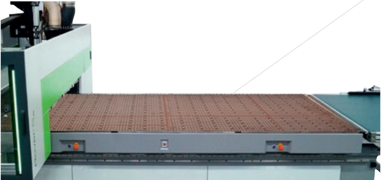
Le verrouillage du vide s'adapte parfaitement à la taille du panneau et permet le passage d'un format à un autre sans opérations manuelles.
