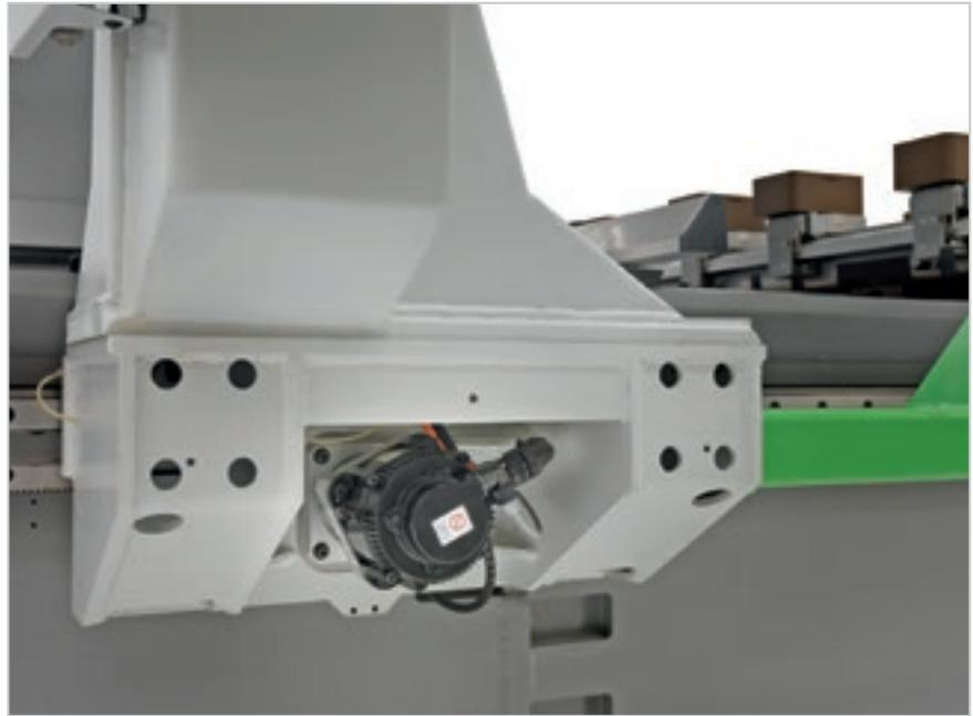
La **double motorisation dans l'axe X** permet d'atteindre des vitesses et des accélérations élevées tout en préservant une haute précision et une grande qualité de finition.
