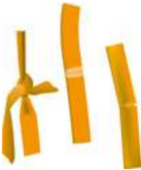
Figure 37 - Principaux défauts présents sur une sangle de levage
