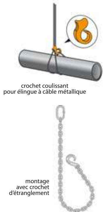
Figure 41 - Élingage en levage bagué
