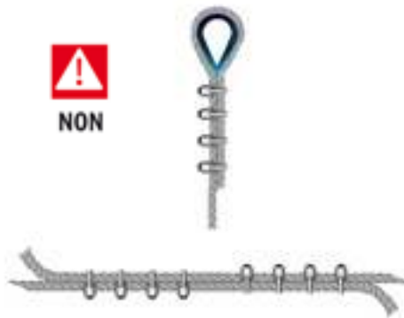
Figure 8 - Assemblages avec serre-câbles
