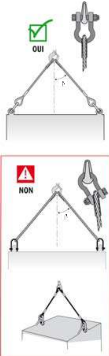
Figure 19 - Montage des manilles
